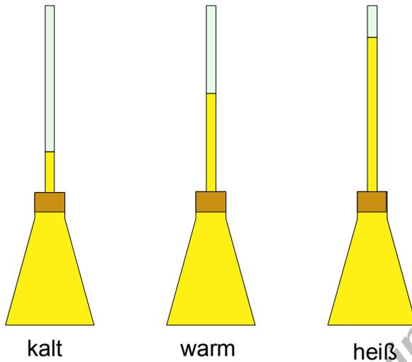
Die Eigenschaft, dass eine Flüssigkeit sich bei Erwärmung ausdehnt, wird bei Flüssigkeitsthermometern benutzt.
