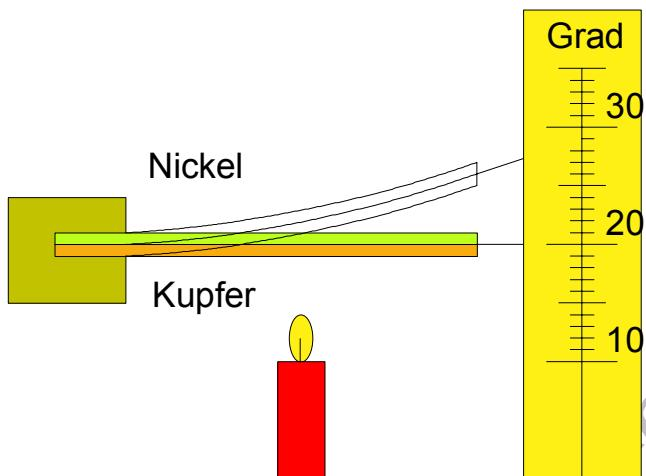
Ein Bimetallstreifen besteht aus zwei Metallstreifen, die fest miteinander verbunden sind. Erhitzt man ihn, so biegt er sich. Bei Abkühlung streckt er sich wieder. Ein Bimetallstreifen kann zur Temperaturmessung benutzt werden.
