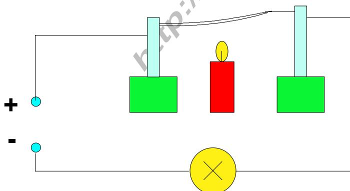
Die Kerze hat den Bimetallstreifen erwärmt. Dieser krümmt sich nach oben und schließt somit den Stromkreis.
