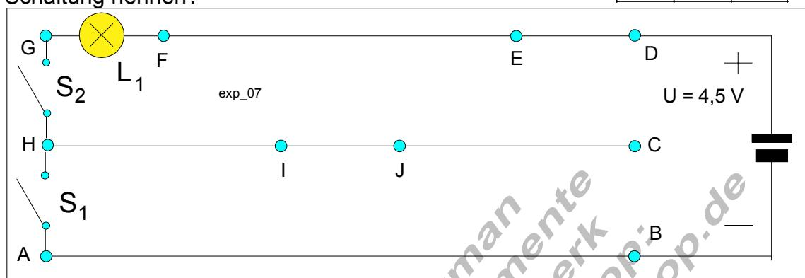
8. Baue die Schaltung mit der Lampe  $L_1$  auf und teste sie. Fülle die Tabelle aus, indem du feststellst, ob die Lampe leuchtet oder nicht.
