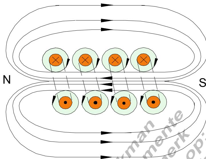
Eine stromdurchflossene Spule verhält sich wie ein Stabmagnet mit abschaltbarem Magnetismus.
