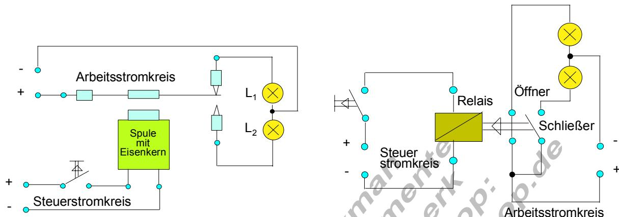
Mit einem Relais lassen sich durch verhältnismäßig kleine Steuerströme große Arbeitsströme schalten.
