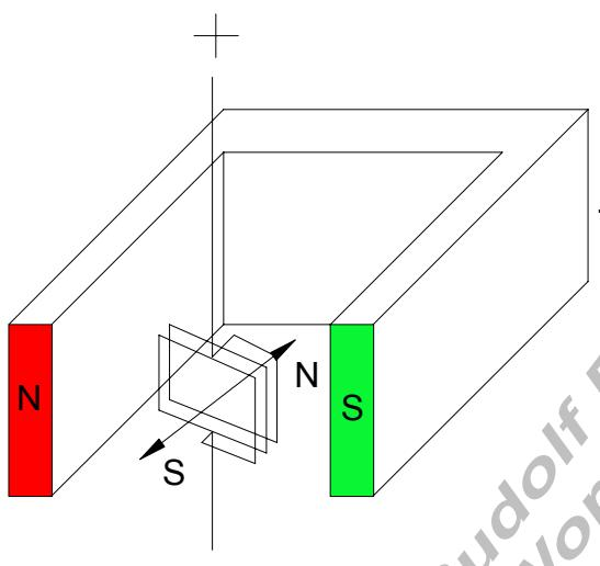
Fließt Strom durch die Spule, so wird diese magnetisch. Sie hat dann einen Nordpol und einen Südpol. Der Südpol der Spule wird vom Nordpol des Magneten angezogen. Der Nordpol der Spule wird vom Südpol des Magneten angezogen. Die Spule dreht sich. Der Draht, an dem die Spule hängt, möchte diese wieder in die Ausgangslage zurückdrehen. Je stärker der Strom, desto größer die Drehung.
