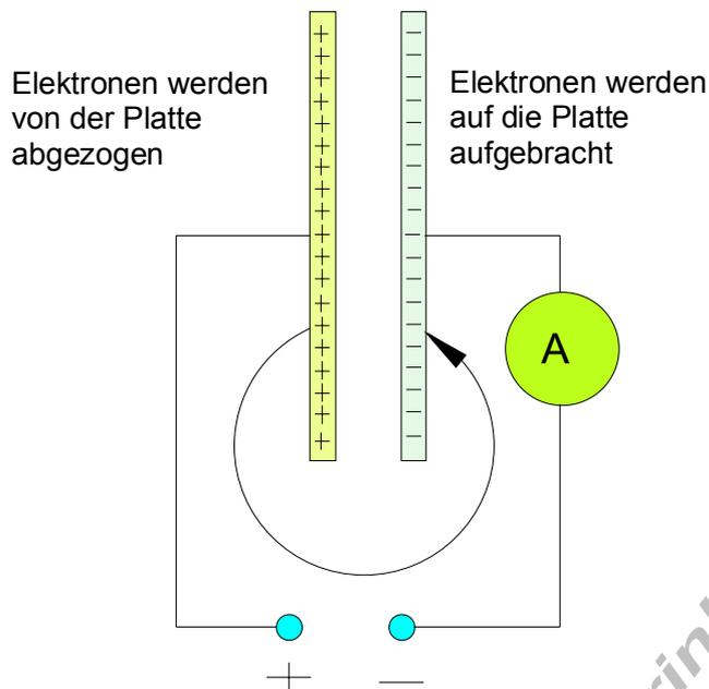
Beim Laden eines Kondensators werden Elektronen von einer Platte auf die andere verschoben. Dabei entsteht ein Ladestrom. Nach entfernen der Spannungsquelle behält der Kondensator seine Ladung.
